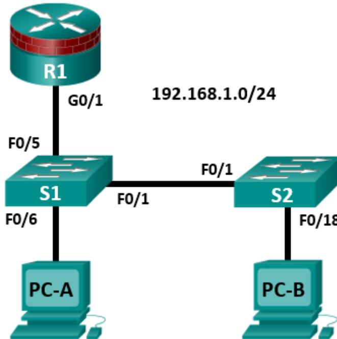
**Примечание.** В устройствах ISR G1 используются интерфейсы FastEthernet вместо GigabitEthernet.
